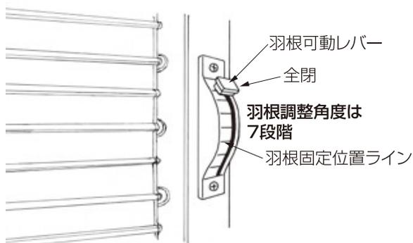
■羽根角度の固定は、羽根固定位置ラインに合わせて「羽根可動レバー」を設定してください。レバーが戻りにくい場合はレバーを押し込んでください。
