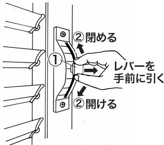
■羽根角度の固定は、羽根固定位置ラインに合せて「羽根可動レバー」を設定してください。
